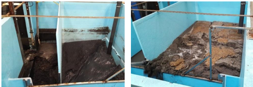
Problemas de sedimentación y acumulación de grasas
