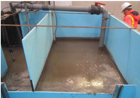
Problemas de sedimentación y acumulación de grasas
