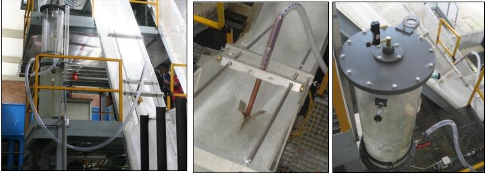
*Figura 3. Sistema de medida de concentración de aire.*
