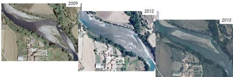
Figura 1. Fotografías aéreas de la barra antes de la extracción (2009), después de la extracción de áridos (2012), y tras su nueva formación (2015).
