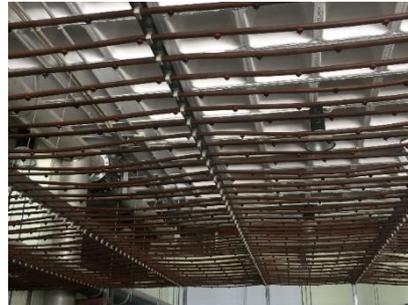
*Figura 1. Simulador de lluvia sobre el modelo físico de un tramo de calle a escala real y detalle de los goteros que generan las gotas.*
