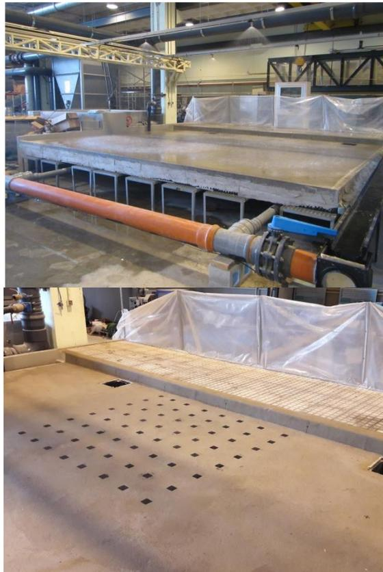
Figura 1. Sección viaria y red de drenaje (arriba) y ejemplo de distribución del sedimento en superficie (abajo)
