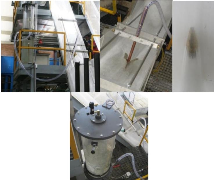
Figura 2. Sistema de medida de velocidad y concentración de aire
