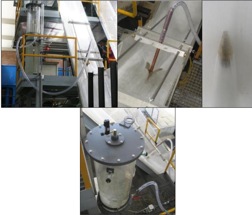
Figura 1. Sistema de medida de velocidad y concentración de aire.
