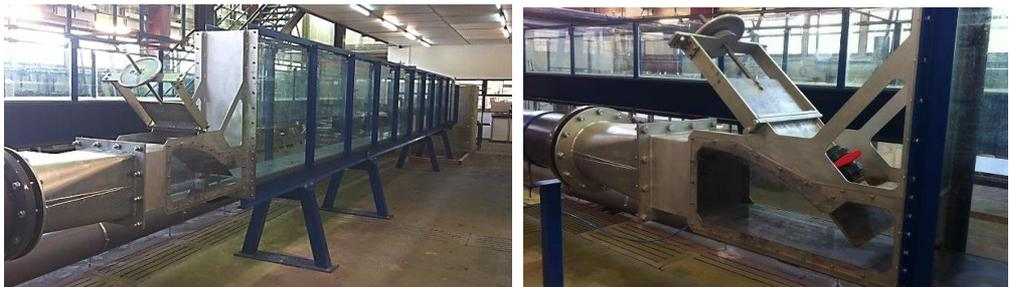
Figura 2. Canal Emulsiona 2. Detalle del dispositivo de alimentación (izda.) y vista general del canal de ensayos (dcha.)
