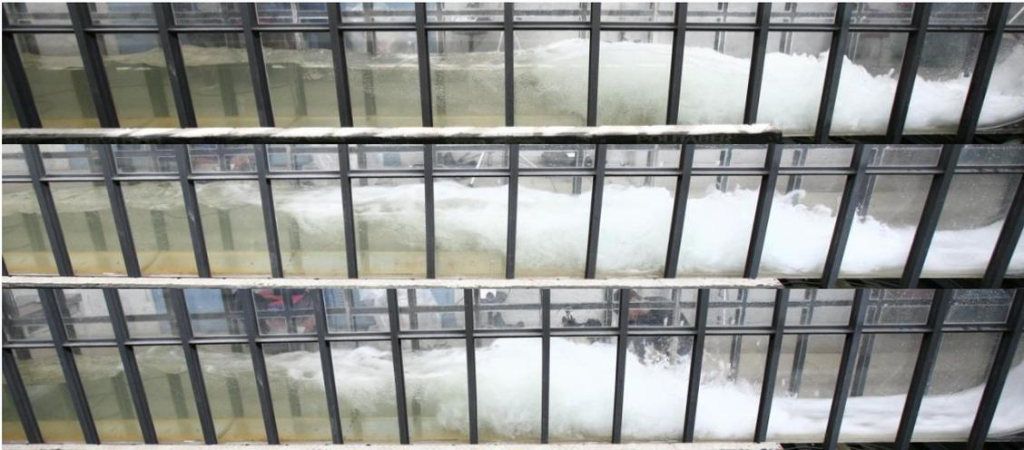
Figura 2. Resalto hidráulico.  $Q_{\text{agua}}=100$  l. A)  $F_1=11.1$   $C=0\%$ . B)  $F_1=12.0$   $C=33\%$ ; C)  $F_1=13.0$   $C=67\%$
