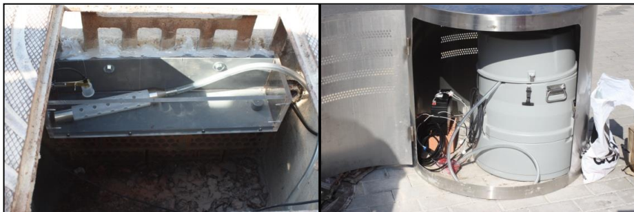
Figura 1. Dispositivo de aspiración aguas abajo del imbornal y automuestreador.
