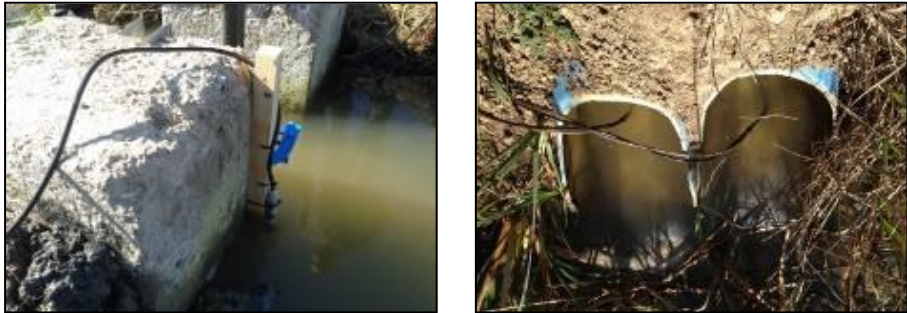
Figura 2. Sonda de nivel en paso intermedio (P5) y sensores de ultrasonidos en salidas (P6).
