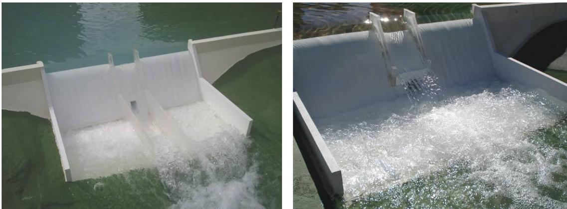
*Figura 1 Comportamiento del modelo físico en situación de Avenida de Proyecto (T=1000 años) para la solución proyectada (izquierda) y para la solución actual (derecha)*
