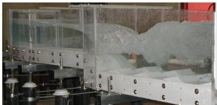
*Figura 1 Subtramo aguas abajo del perfil WES (Caudal de diseño)*
