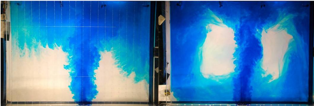
Figura 1. Resultado de los experimentos del flujo entrante en el medio con y sin vegetación emergente.
