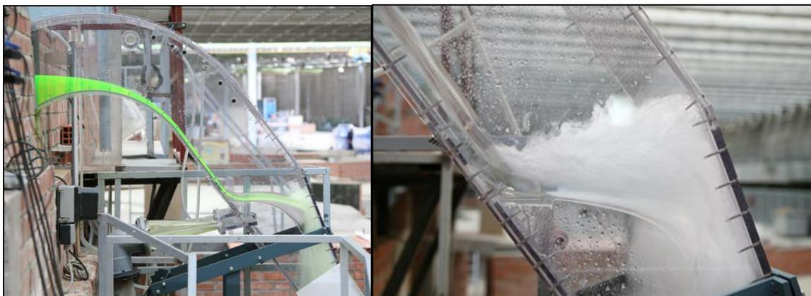
Figura 17. Detalle del deflector de estanqueidad
