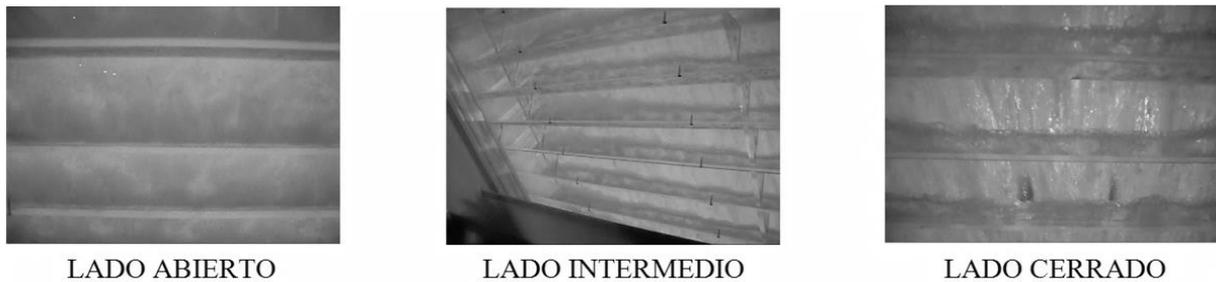
Figura 6. Vista posterior de la expansión lateral respecto al llenado de los escalones. Se puede apreciar flujo rasante en el “lado abierto” y flujo escalón a escalón en el “lado cerrado”. Ensayo  $b_{0 \text{ prot}} = 22.5 \text{ m}$  y  $q_{e \text{ prot}} = 6 \text{ m}^3/\text{s}/\text{m}$ .
