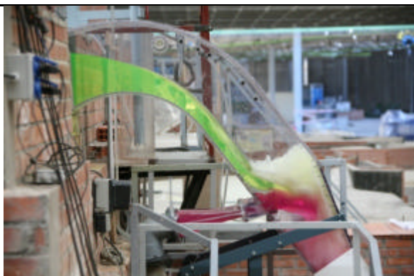
Instalación para experimentación de aliviaderos en sifón
