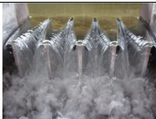
Instalación para experimentación de aliviaderos en laberinto y en tecla de piano
