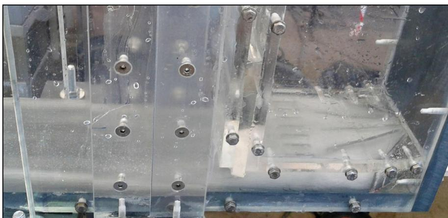
Figura 5. Dispositivo para transición flujo en presión ó lámina libre con emulsiónamiento del flujo (UPV).
