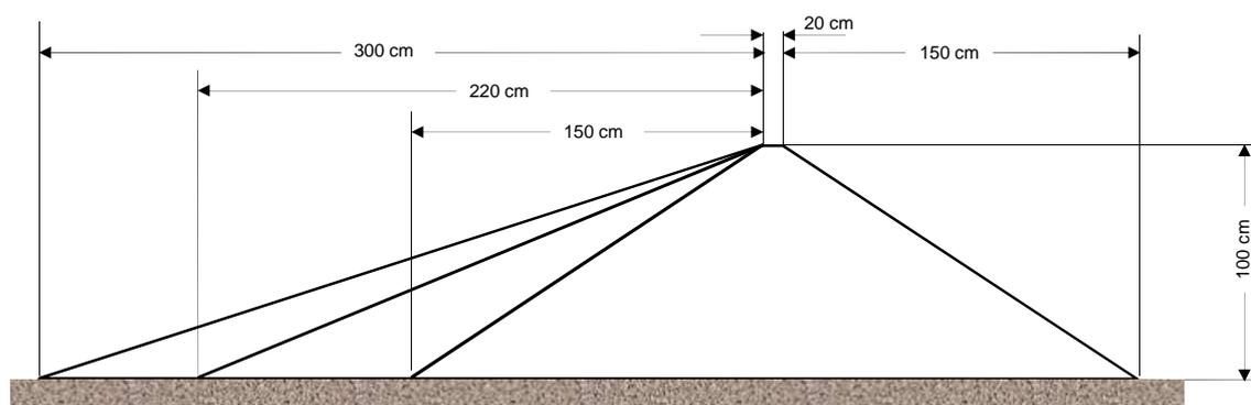
Figura 1 Esquema de las presas del canal mediano
