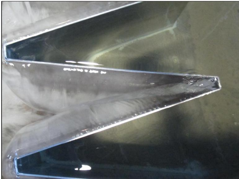
Finalmente la aproximación a los vértices de aguas abajo, con el agua ya en el dominio del laberinto, se encuentra condicionada por la evacuación en las caras diagonales que confluyen en ese vértice, de tal manera que se produce una depresión gradual de la lámina distinta de la que tiene lugar en un vertedero en pared delgada.
