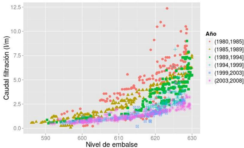
Figura 17: Caudal de filtración en el aforador ötotmiö en función del nivel de embalse, con división de datos por períodos.
