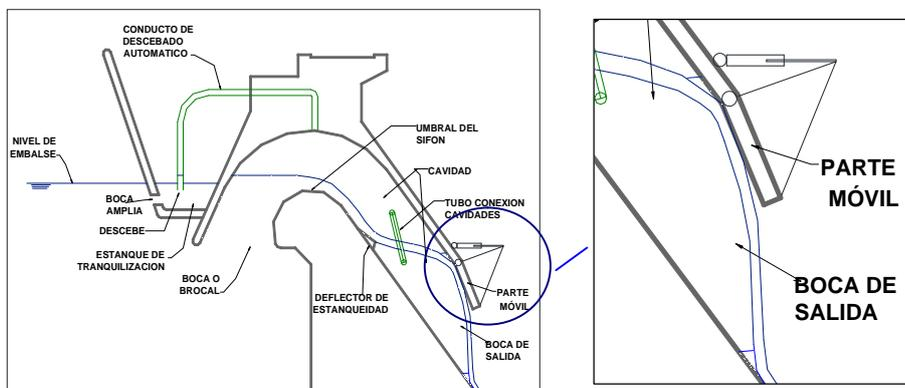
Figura 5. Sifón con sección de salida variable
