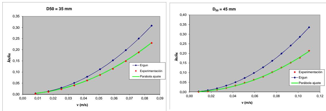
Figura 8 Comparación entre el gradiente hidráulico según Ergun y los ensayos del CEDEX
