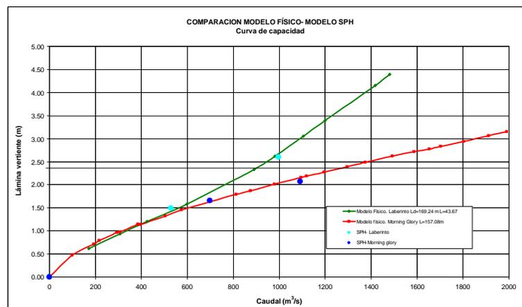
Figura 11. Comparación de curvas de gasto. Modelo físico vs. SPH.
