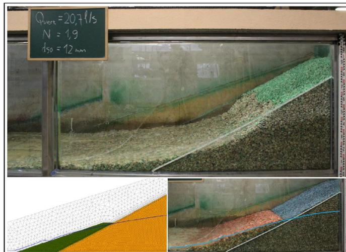
Figura 4. Montaje correspondiente a unos de los ensayos de validaci on del procedimiento de dise o. Foto superior: presa Desprotegida, con caudal unitario de percolaci on de 15,7 l/s/m. Figura inferior: modelo de filtraci on correspondiente al caudal de dise o (16 l/s/m). Foto inferior: protecci on con caudal de percolaci on  $q_s=15,9$  l/s/m.
