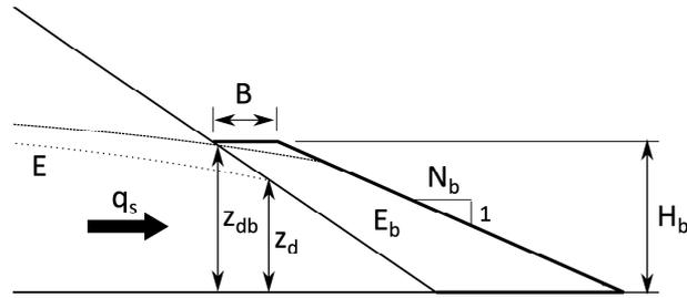
Figura 2. Esquema de los parámetros de diseño de la protección tipo repié
