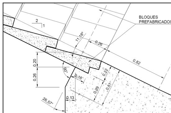
Figura 9. Unión entre canal de descarga y trampolín
