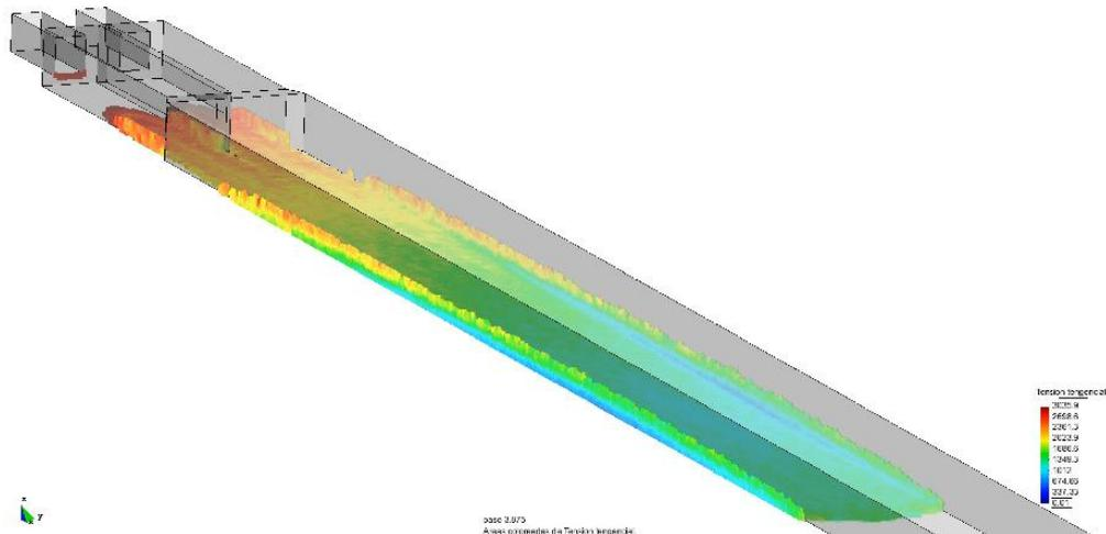
Figura 15. Desagüe de fondo de la presa de Mularroya. Tensiones en el contorno
