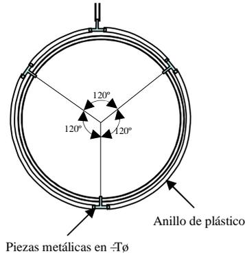
Figura 6 Diseño de medida en una sección transversal
