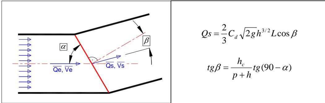
La sola aplicación del teorema de la cantidad de movimiento para calcular la capacidad hidráulica de un vertedero tipo laberinto ofrece resultados tan aproximados como pueden ofrecer los procedimientos experimentales habituales para el cálculo de estas estructuras.
