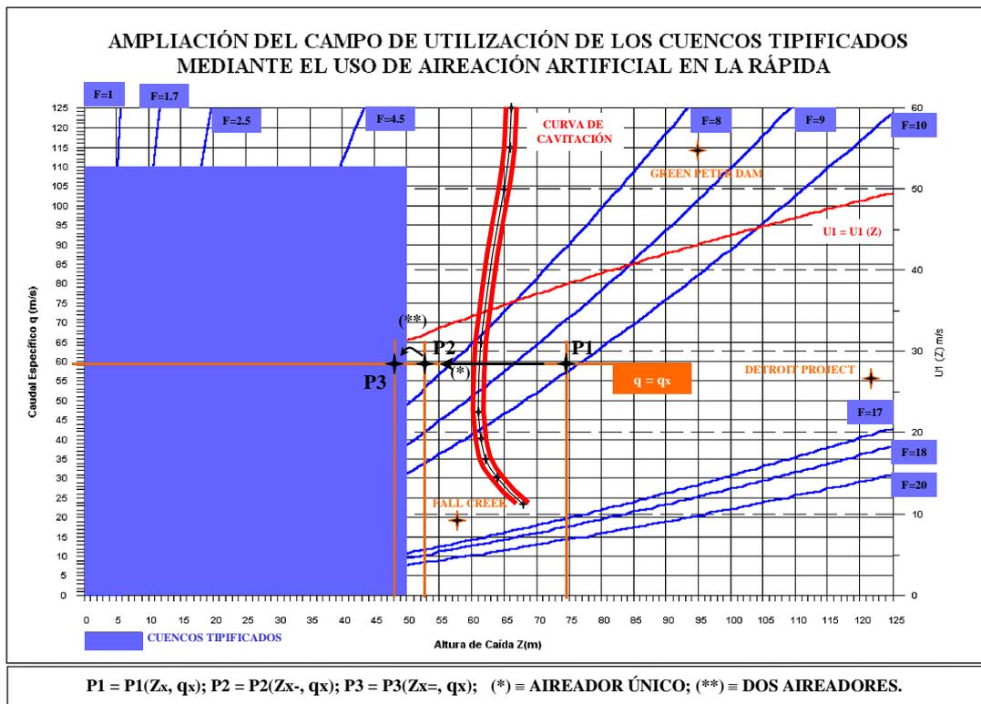
Figura 2. Efecto de la Aireación del Flujo sobre las condiciones de entrada al cuenco. Curva de Cavitación.
