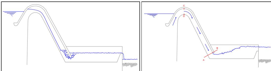
Figura 1. Sifón con boca de salida anegada
