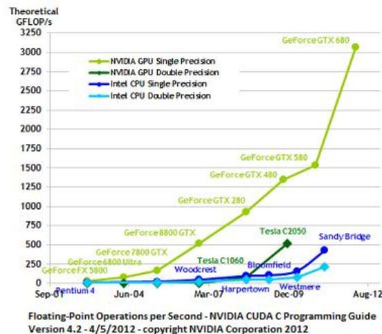
Figura 16. Comparación de capacidades de cálculo CPU vs. GPU
