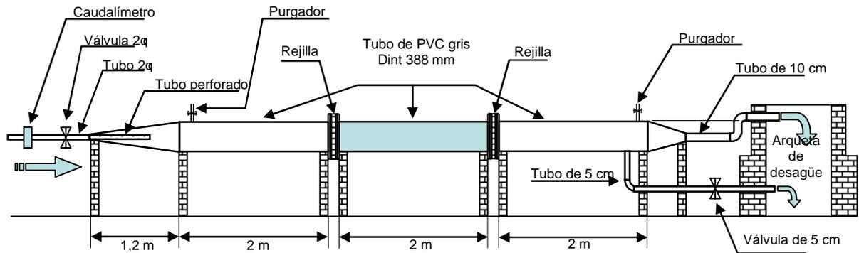
Figura 4 Esquema del equipo de ensayo
