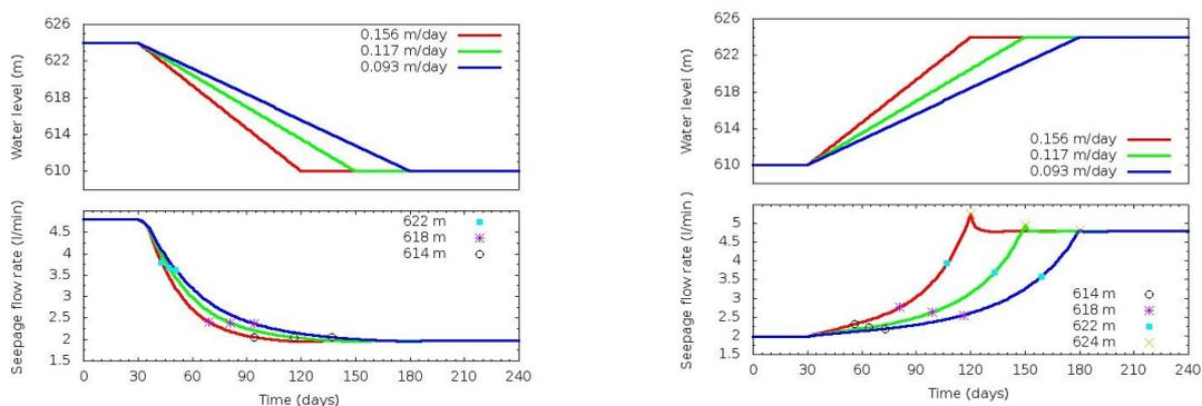
Figura 7. Resultado proporcionado por un modelo de redes neuronales al considerar el descenso y el aumento del nivel del embalse a lo largo de un período de cinco meses con distintas velocidades de variación del nivel del embalse
