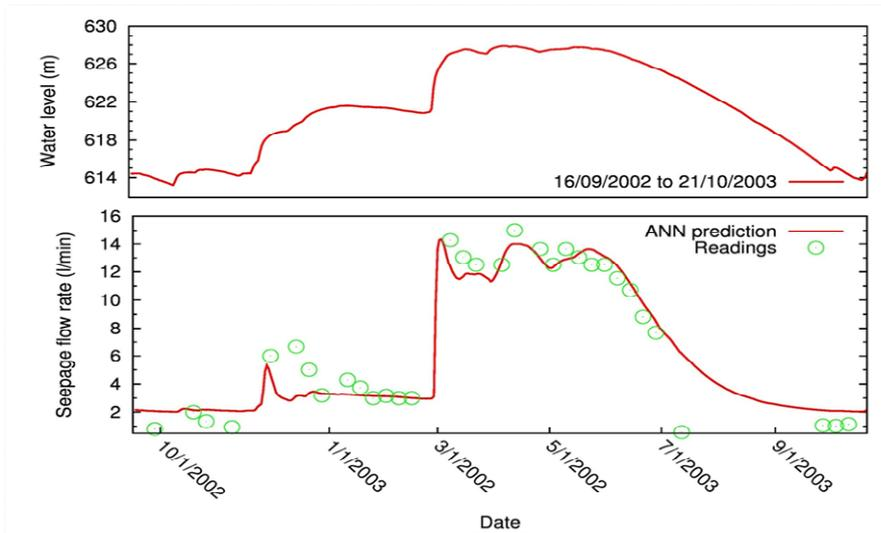
Figura 8. Datos registrados en un aforador y su modelación mediante una red neuronal, que parece haber capturado el comportamiento complejo con efecto de "rebote" después de un ascenso de nivel prolongado
