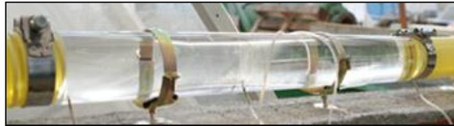
Figura 16. Venturímetro para aforo de aire
