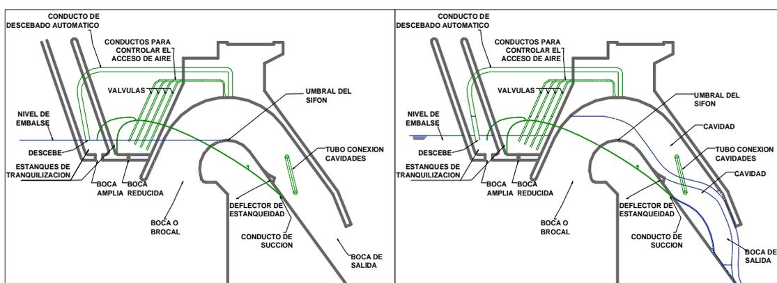
Figura 10. Sifón con cebado gradual autónomo modificable
