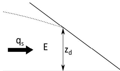
Figura 3. Altura de surgencia de la línea de saturación sobre el espaldón de la presa sin protección (z<sub>d</sub>)
