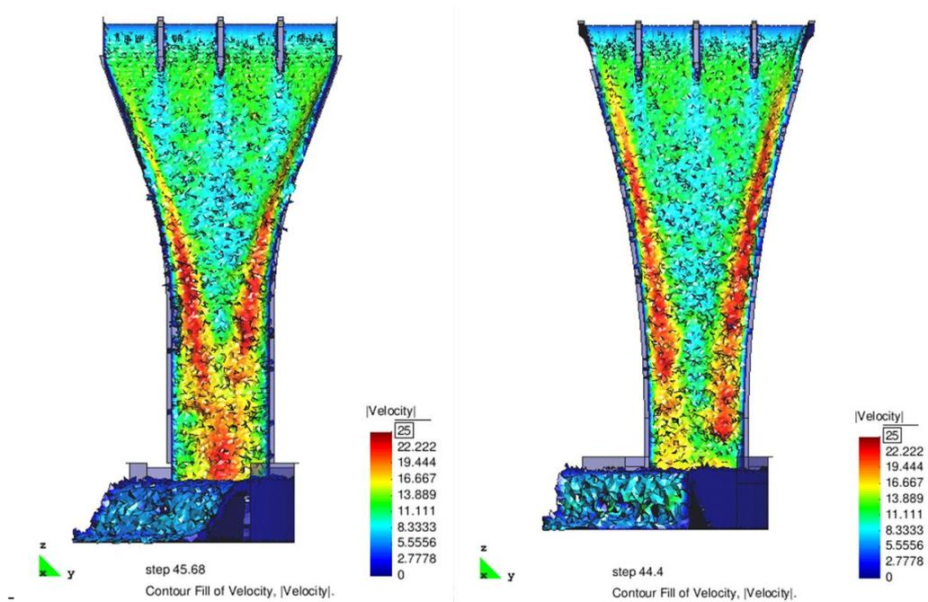
Figura 2. Vista en alzado del modelo numérico del aliviadero de la presa de Itoiz. Izquierda: diseño original. Derecha: diseño final.
