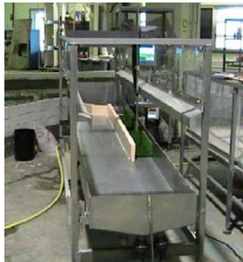
Fotografía del canal de ensayo con hierba artificial
