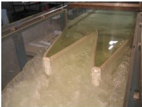
Figura 1. Aliviadero en laberinto. "Half-Round", con ángulo \alpha=12^\circ (Fuente: Crookston, 2010).
