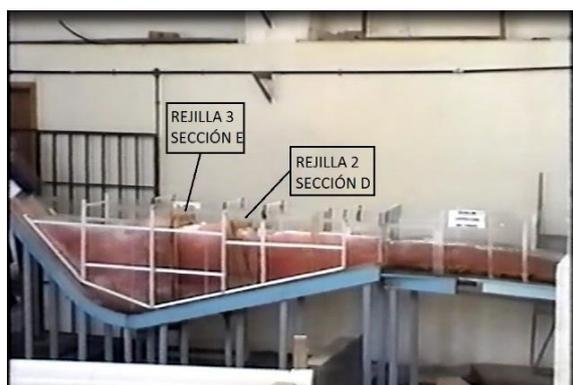
Figura 4. Prototipo optimizado,  $Q = 50l/s$ ,  $q_M = 3.7 q_0$ .
