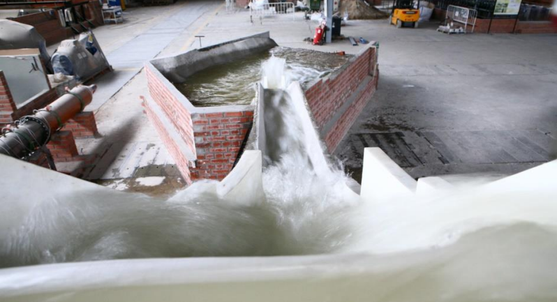
Physical modelling Angostura Dam (Perú)
